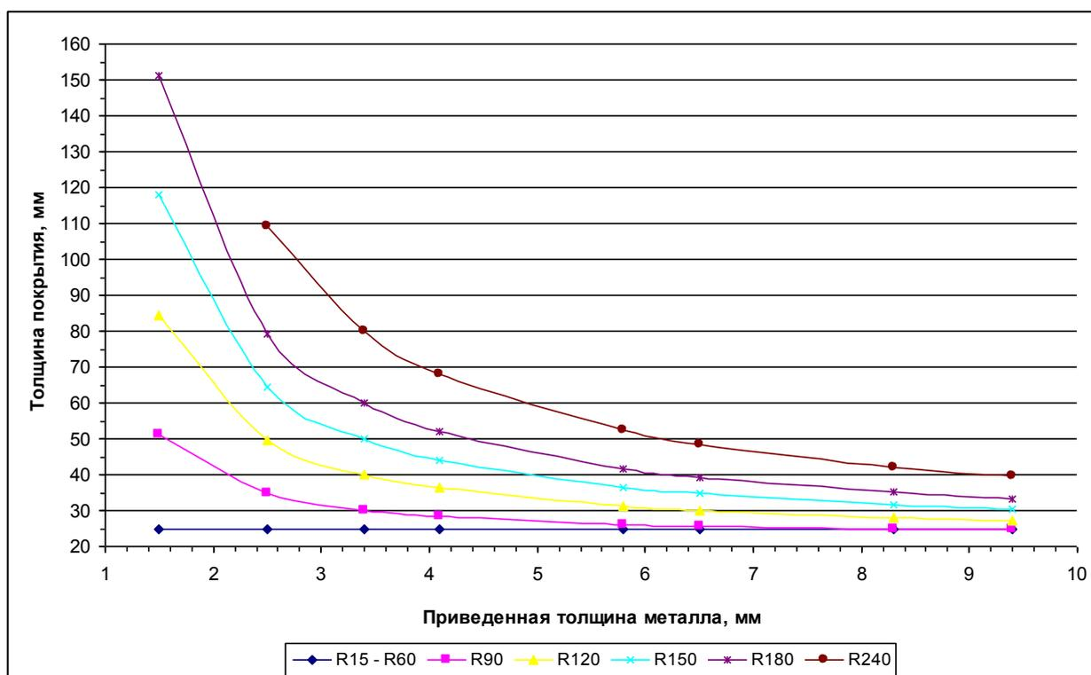
Рисунок 1. Зависимость толщины плиты EURO-ЛИТ плотностью 150 кг/м<sup>3</sup> от требуемого предела огнестойкости стальной конструкции и приведенной толщины металла при критической температуре стальной конструкции 500 °С
