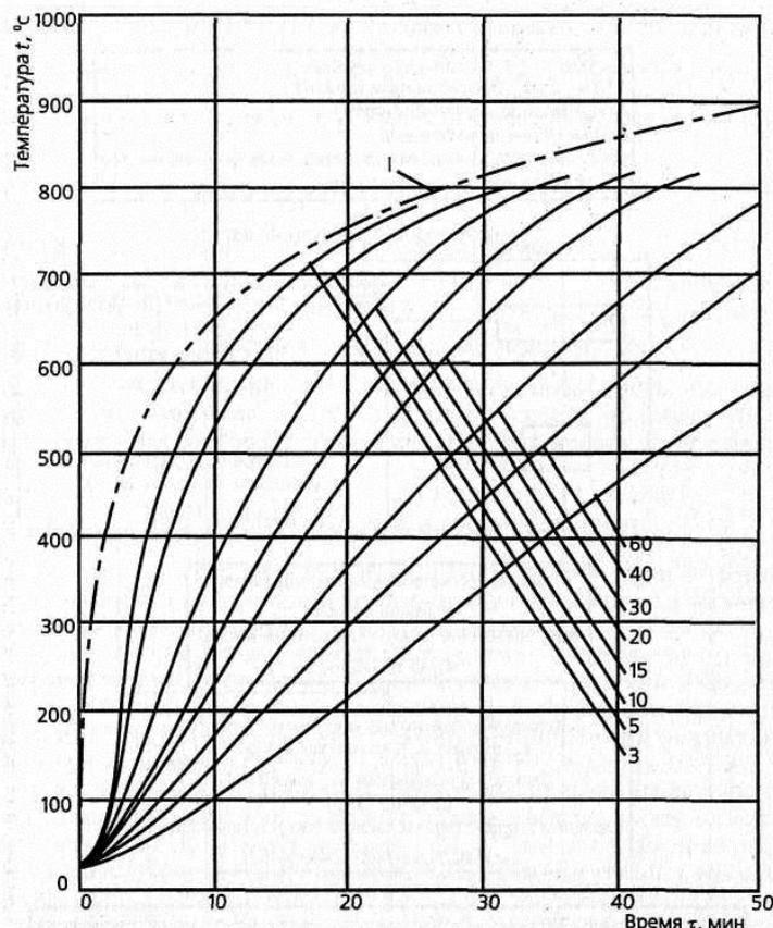
Рисунок 2. Зависимость температуры незащищенных элементов стальных конструкций от времени нагрева по режиму «стандартного» пожара (кривая I). Цифры у кривых соответствуют приведенной толщине металла  $t_{red}$ , мм.
