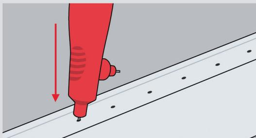
Закрепите соединения пластиковыми заклепками, вставляя их в отверстия с помощью шила.
